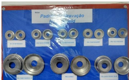
Figura 3 – Modelos de defletores térmicos.
