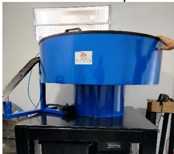
Figura 6 – Panela vibratória para alimentação.
