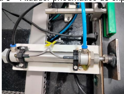
Figura 8 – Atuador pneumático de expulsão.
