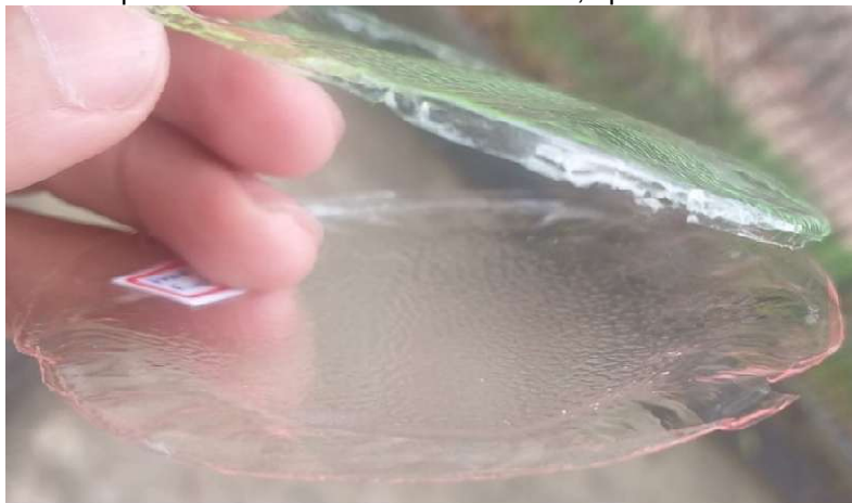
Figura 3 - Filmes poliméricos excitados com luz solar, apresentando luminescência.
